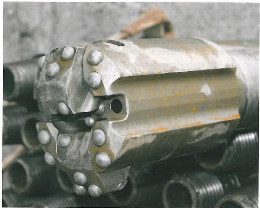
Abb. 4 Exzentermeißel, der bei den Arbeiten in Freiburg erfolgreich zum Einsatz kam.
